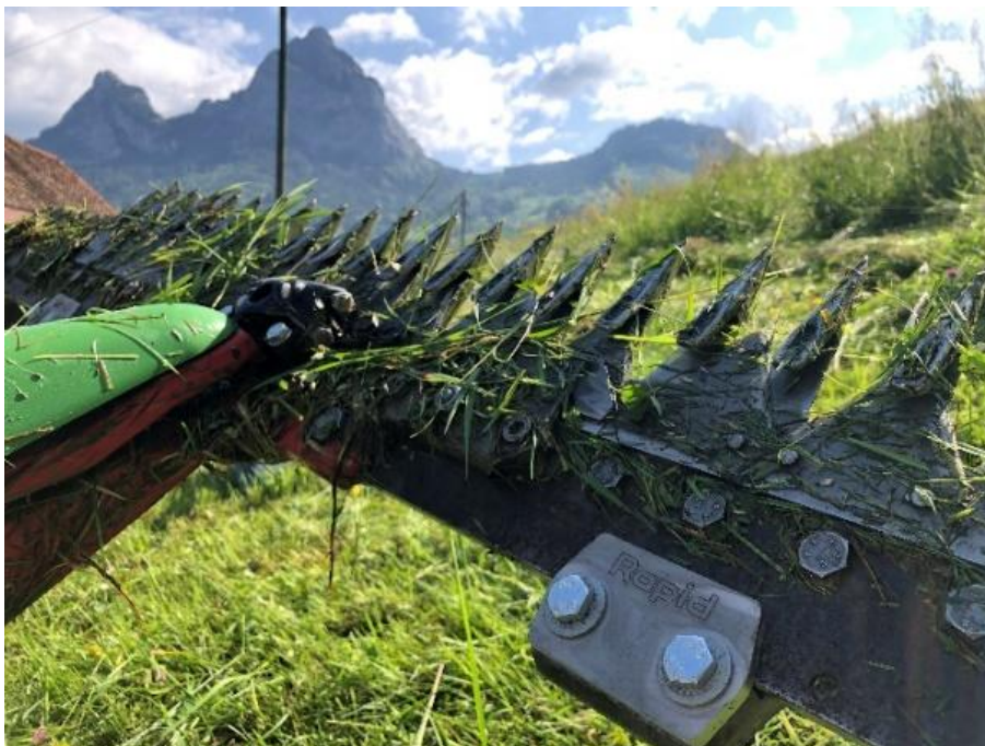
Abbildung: Klemmsohle und Klemmsohle LP als Option für Fingerbalken/Kommunalbalken
